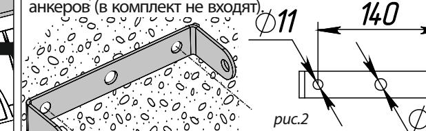
1.Закрепите светильник на кронштейн (рис.1,3).
